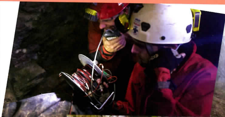
Plus d'un kilomètre de câble est déroulé du PC au cœur des galeries pour maintenir une communication permanente entre le sous-sol et la surface.
